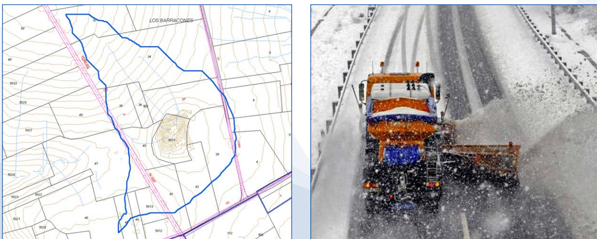
Figura 3. Izquierda. Superficie afectada por la cuenca vertiente (línea azul) del Lavajo del Jaral. Nótese cómo la carretera divide la cuenca en su extremo inferior. Derecha: Máquina quitanieves en acción, nótese la altura y el alcance de la nieve al ser desplazada por la pala dozer (Fuente: ABC).
