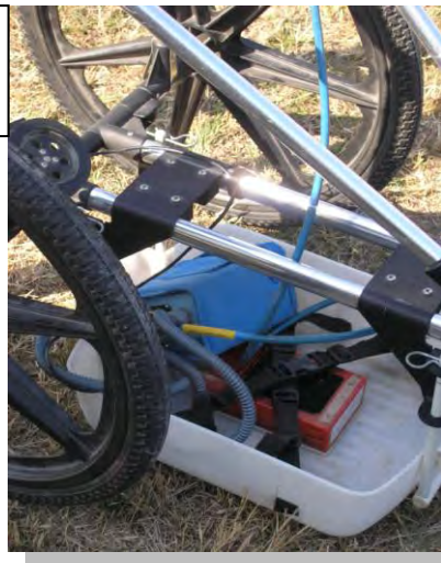
Figura 2. Equipo de georradar utilizado en la Fase II montado en carrito con marcación automática (odómetro).
