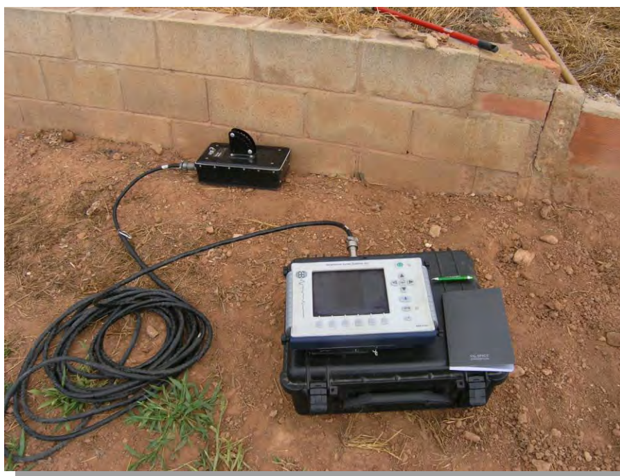
Figura 5. Perfil de georradar en el mismo margen del muro realizado de forma manual con la antena de 900 MHz
