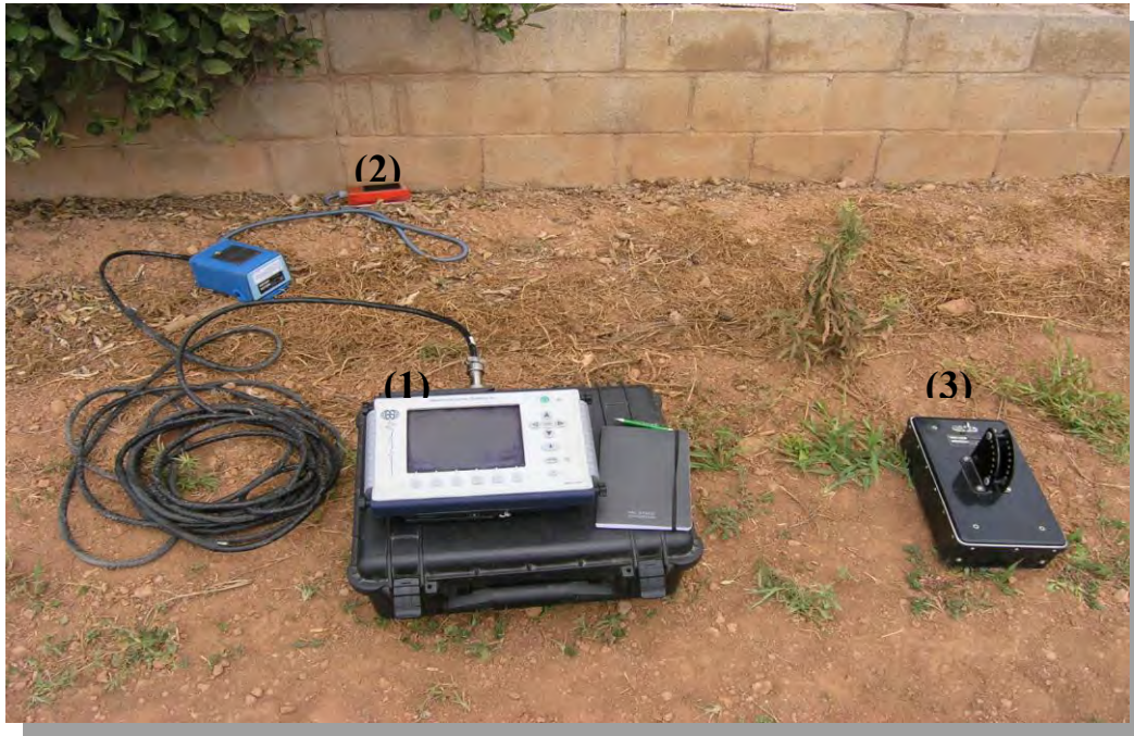
Figura 1. Equipo de georradar utilizado en la Fase II: (1) SIR3000; (2) antena 1,6 GHz; (3) antena 900 MHz.
