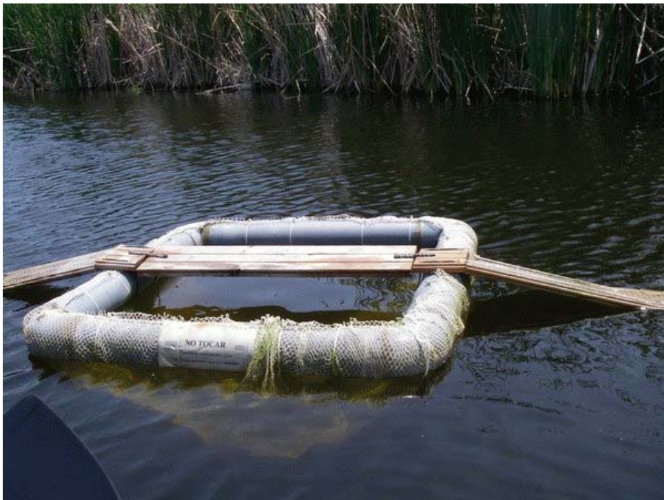
Figura 4: Trampa flotante basculante.
