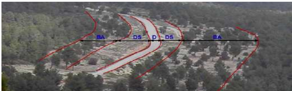
Figura 91. Ejemplo de cortafuego estructural apoyado sobre vial.
