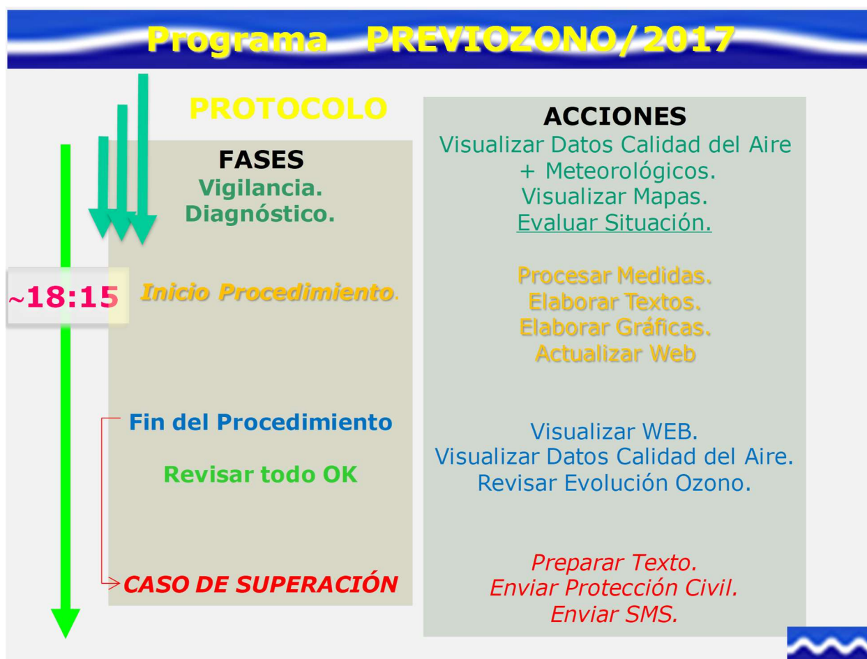
Figura 3: esquema del flujo de tareas durante una jornada tipo de vigilancia intensiva
