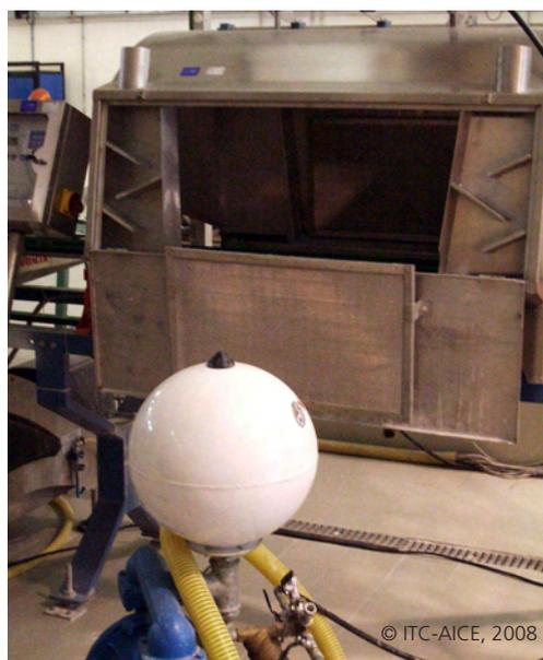
Figura 13. Sistema de esmaltado por pulverización con aerógrafo.
