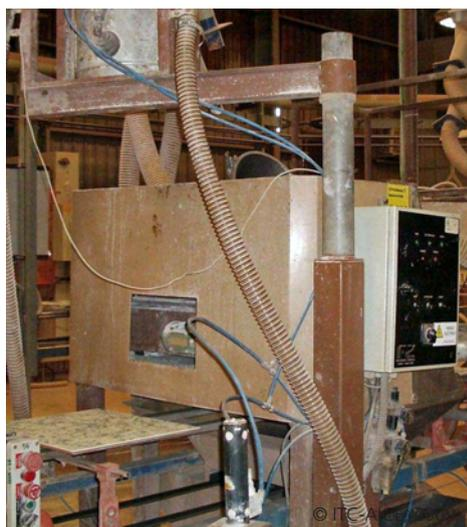
Figura 14. Decoración en seco mediante granillas.
