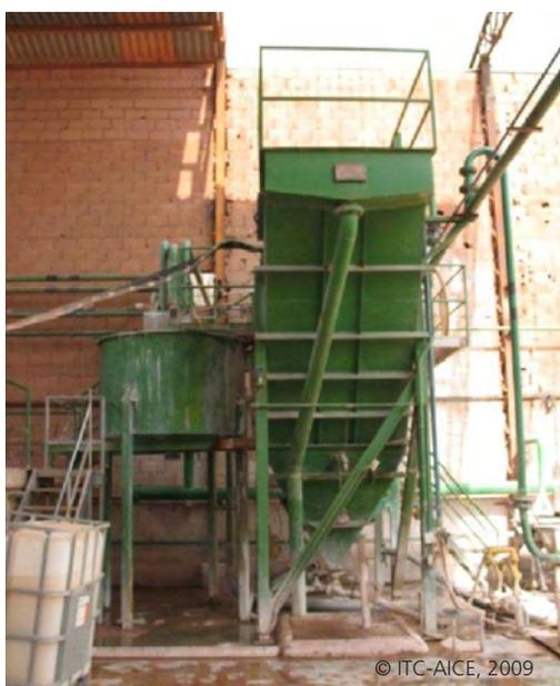
**Figura 30.** Sedimentador de lamelas.
