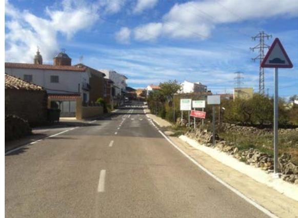
*Actuación encaminada a mejorar las condiciones de seguridad a la llegada a la población y moderación de la velocidad en la travesía, con actuaciones integrales de repavimentación, estrechamiento de carriles y ensanche del eje con creación de refugios centrales en los pasos peatonales (en previsión de uso por personas de elevada edad o movilidad reducida), así como la adecuación de aceras.*
