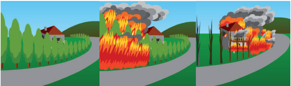
Fuego propagándose al interior de la construcción a través del seto
